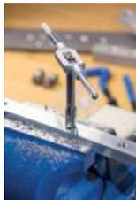
Schritt 2: Gewinde schneiden
