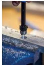
Schritt 3: Einbau des Gewindeeinsatzes
